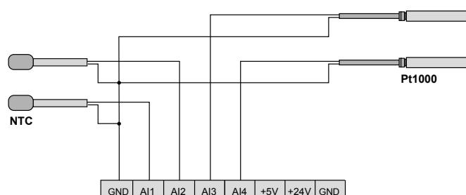
Transducer connection / Connessione trasduttore / Conexión del transductor / Anschluss der Signalwandler / Connexion du transducteur / Conexão do transdutor
