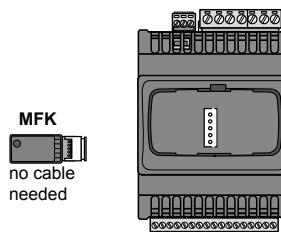
Connection of Programming Cable (DMI 100-3). / Connessione del cavo di programmazione (DMI 100-3). / Conexión del cable de programación (DMI 100-3).
