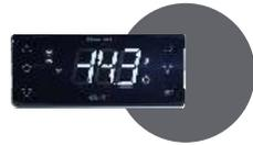
Регулятор Нагрева или Охлаждения имеет дифференциал между срабатыванием и отпусканием и работает по значению датчика PB1 независимо от того выбран ли режим Нагрева или Охлаждения.
