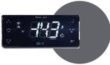
Когда температура с регулируемого датчика 1 становится ниже порога **sCP** в течение времени не менее **tCP**, то включается защита от переохлаждения: с целью попытаться обогреть рабочий объем контроллер включает свет и вентилятор пока температура не поднимется до уровня **sCP + dCP**.
