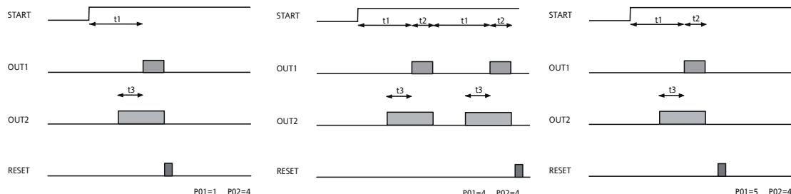
При задании **P01= 2 или 3** режим работы OUT2 аналогичен режиму работы OUT1, но в качестве интервала работы применяется интервал **t1-t3** вместо **t1** для OUT1:
