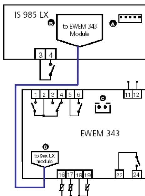
Для подключения контроллеров серии IS (блоков управления) к слэив модулям EWEM (силовым блокам) требуются кабель «CAVO TELEFONICO» с двумя телефонными разъемами на десять контактов. Кабель сигнальный двунаправленный, поэтому нет никакой разницы каким разъемом и в какой прибор его подключать. Длина кабеля может быть от 0,5 до 4-х метров (по заказу).
