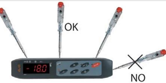
Прибор разработан для установки на панель в отверстие размером 150x31 мм. Закрепить прибор можно с лицевой стороны шурупами (в комплекте), которые устанавливаются после снятия крышки лицевой панели, или же стандартными фиксаторами с тыльной стороны.
