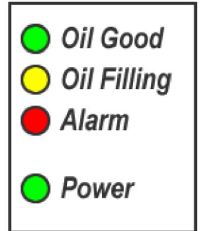
**Циклы пополнения** продолжаются даже при наличии аварии пытаюсь пополнить уровень масла до требуемого уровня; если этот уровень будет достигнут, то циклы пополнения прекратятся, и аварийный сигнал автоматически снимется.
