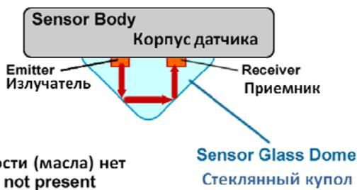
При отсутствии жидкости (масла) весь поток, выдаваемый Излучателем передается к Приемнику и, таким образом, RK30 обнаруживает отсутствие жидкости в системе и запускает процедуру ее пополнения.
