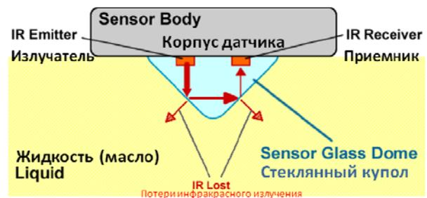
При наличии жидкости (масла) основная часть потока «теряется» и, таким образом, RK30 обнаруживает наличие достаточного уровня жидкости в системе и не запускает процедуру ее пополнения.
