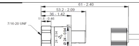
Датчики давления (TD32xxxxB) с токовым сигналом 4...20мА и присоединением с внутренней резьбой (Female - Мама) - IP67
