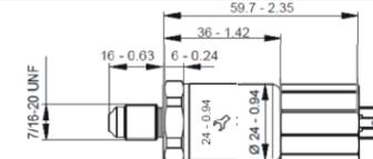
**Датчики давления (TD25xxxxB) с токовым сигналом 4...20мА и присоединением с внешней резьбой (Male - Папа) - IP65**
