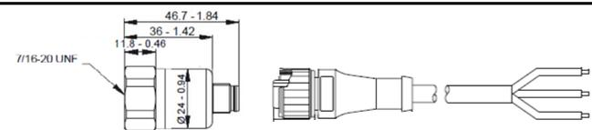
Датчики давления (TD34xxxxB) с токовым сигналом 4...20мА и присоединением с внутренней резьбой (Female - Мама) - IP67
