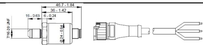
Датчики давления (TD24xxxxB) с токовым сигналом 4...20мА и присоединением с внешней резьбой (Male - Папа) - IP67
