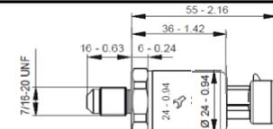
**Датчики давления (TD25xxxxB) с токовым сигналом 4...20мА и присоединением с внешней резьбой (Male - Папа) - IP67**
