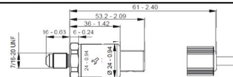
Датчики давления (TD22xxxxB) с токовым сигналом 4...20мА и присоединением с внешней резьбой (Male - Папа) - IP67
