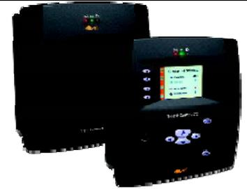
**Блоки TelevisCompact 600 (мини-ПК с сенсорным дисплеем и кнопками для обеспечения локального доступа) с предустановленным ПО**
